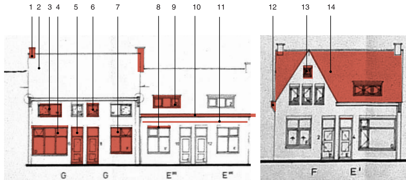
1. gemetselde schoorstenen, 2. dakvlak met dakpannen (zadeldak), 3. enkel laag venster met boven- en onderraam, 4. winkelvenster: hoog venster met boven- en onderraam en een wit versierde latei, 5. deur met bovenlicht (entreepartij bestaat uit twee deuren naast elkaar), 6. klein venster boven entreepartij, 7. hoog venster met boven- en onderraam, 8. aanzetten latei in metselwerk, 9. dakkapellen met drie vensters, 10. verspringende dakgoot met klossen, 11. metselwerkband, 12. gemetselde hoekaccent tussen dak- en gevelvlak, 13. venster onder puntgevel, 14. dakvlak met dubbele puntgevel. De tekeningen laten de situatie van na de renovatie in 1985 zien. [Portaal]
